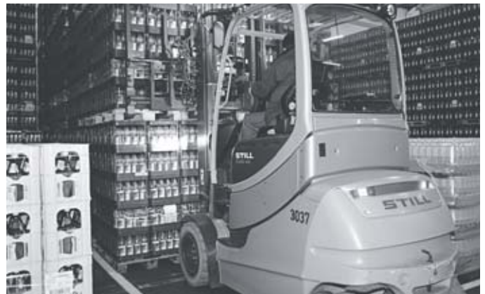
Goed zicht over hoge lasten dankzij de hogere bestuurdersstoel
