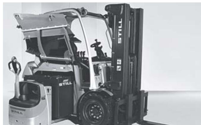
Eenvoudig zijwaarts vervangen van de batterij met pallettruck en wisselrek
