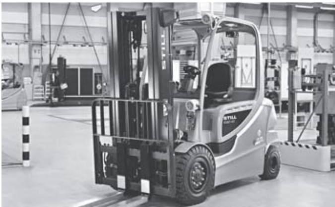
EX beschermde uitvoering met ingesloten elektrische componenten
